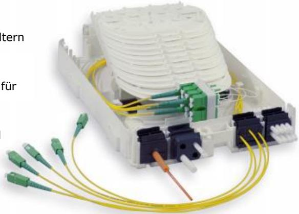
Dem BBT Gf-APL MAX liegt folgender Dichtungssatz bei: 1x  $\varnothing 10$  mm, 2x  $\varnothing 7$  mm, 1x 2x  $\varnothing 7$  mm, 3x 12x  $\varnothing 5$  mm, 2x 24x  $\varnothing 3$  mm. Jede Dichtung passt in jede Durchführung.
